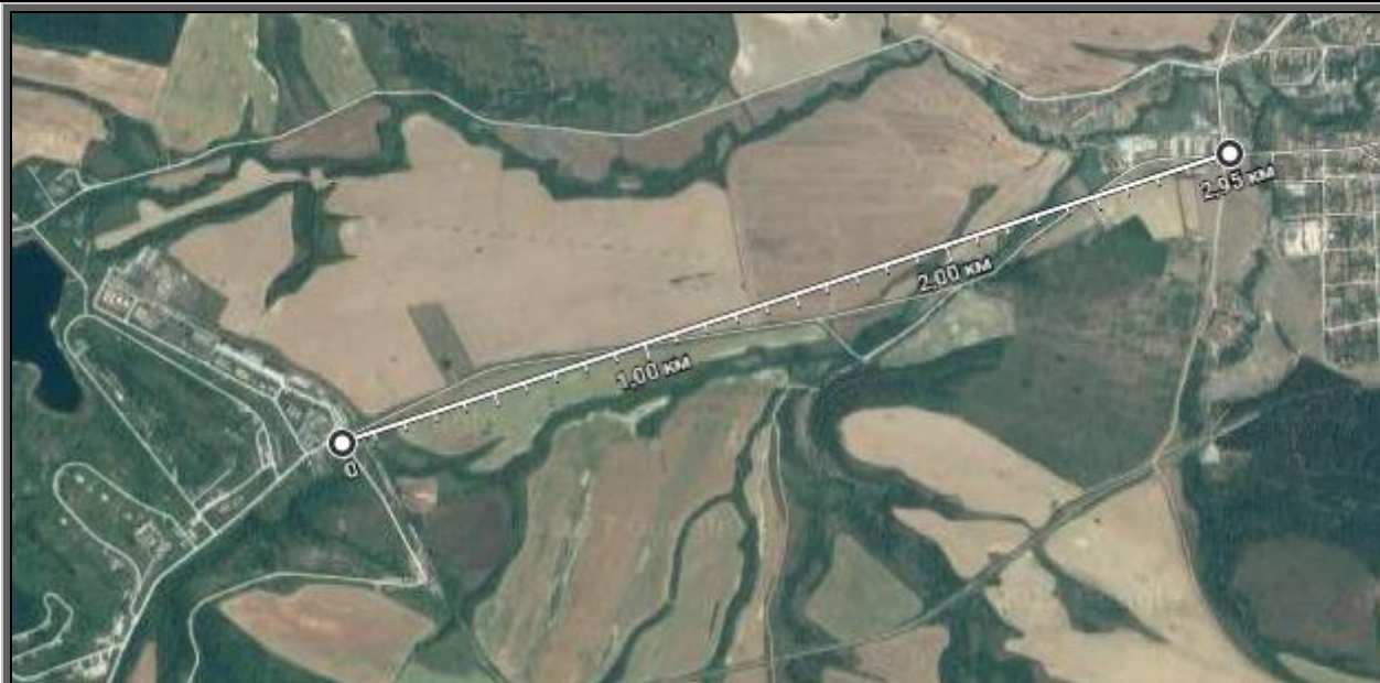
Фиг.№20 Отстояние от складовете за съхранение на взривни материали до жил.зони-2995 м.
